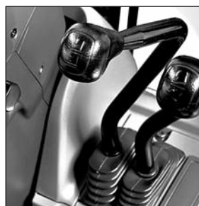
Palancas hidráulicas instaladas en el salpicadero
